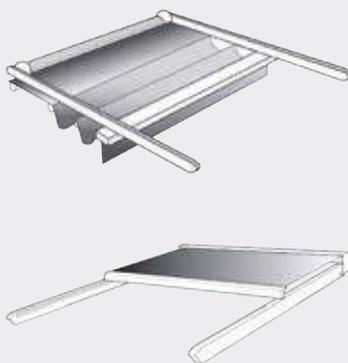
En las pérgolas con ondas el motor se para automáticamente cuando alcanza la posición de máxima extensión: para memorizar el fin de carrera basta con seguir la secuencia correspondiente desde el emisor. Desde este momento el motor cada vez que alcanza la posición de fin de carrera de apertura se para manteniendo la lona siempre en tensión.
